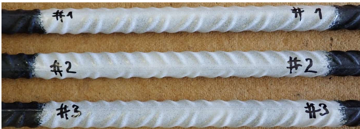
Abbildung 8: Anker mit Kunststoffbeschichtung vor dem NSS-Test.
