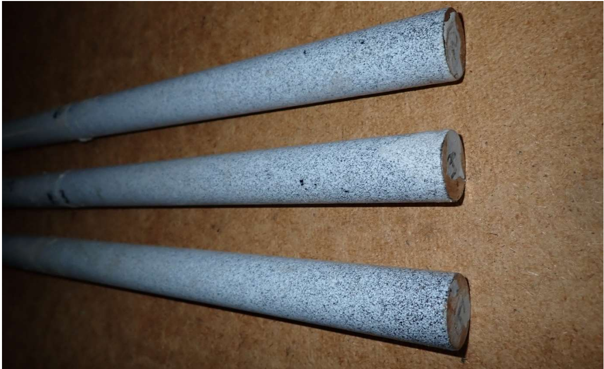
Abbildung 2: Oberfläche der Dübel nach der Auszugsprüfung ohne Beschädigung der Beschichtung
