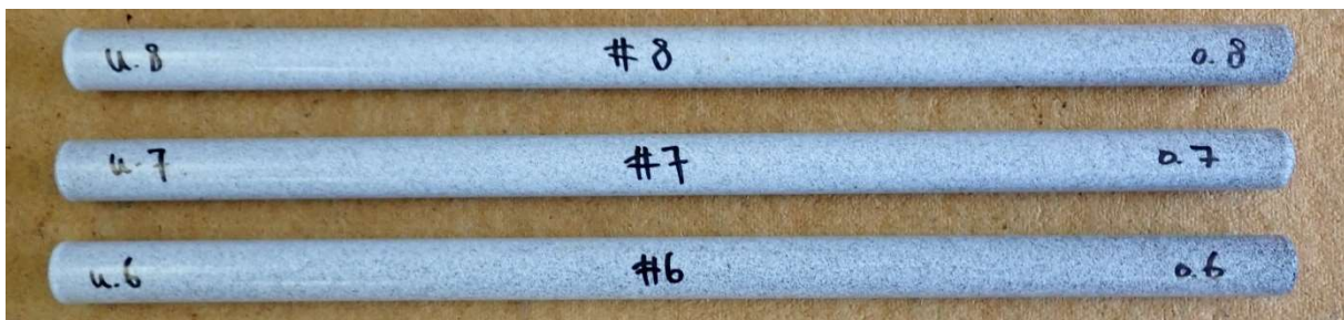
Abbildung 5: Rückseitige Oberfläche der beschichteten Dübel vor dem NSS-Test.
