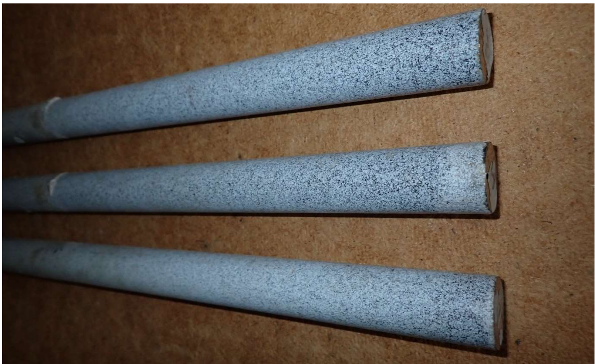
Abbildung 3: Rückseitige Oberfläche der Dübel nach der Auszugsprüfung ohne Beschädigung der Beschichtung
