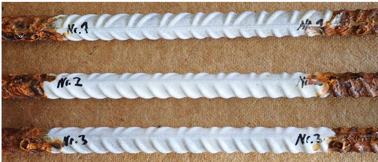
Abbildung 11: Rückseitige Oberfläche der Anker nach NSS-Test ohne Korrosionsmarken oder Risse der Beschichtung im betrachteten Bereich.
