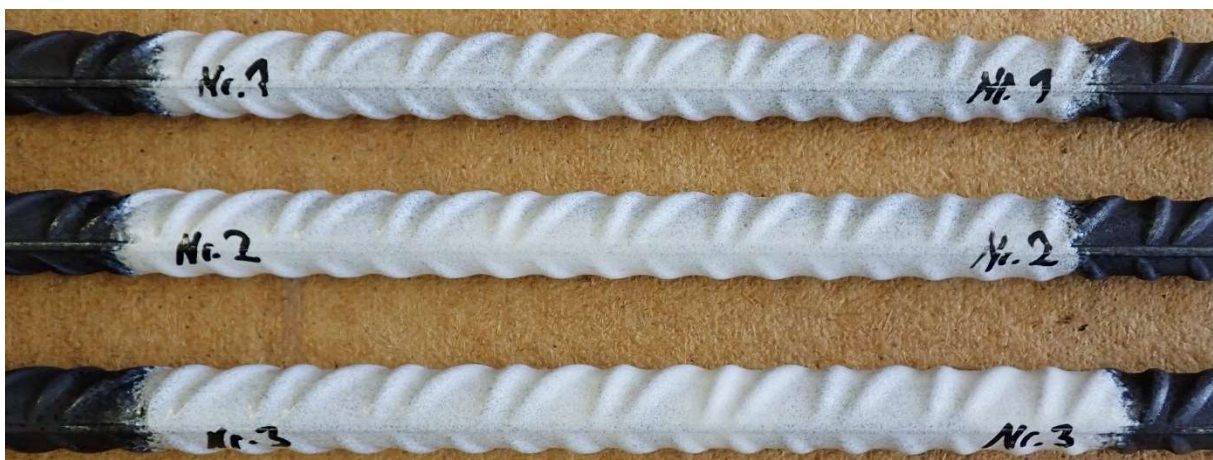
Abbildung 9: Rückseitige Oberfläche der beschichteten Anker vor dem NSS-Test.
